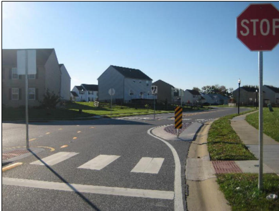
شکل ۴-۷- نمونه منحرف‌کننده جانبی در تقاطع سه‌راه
