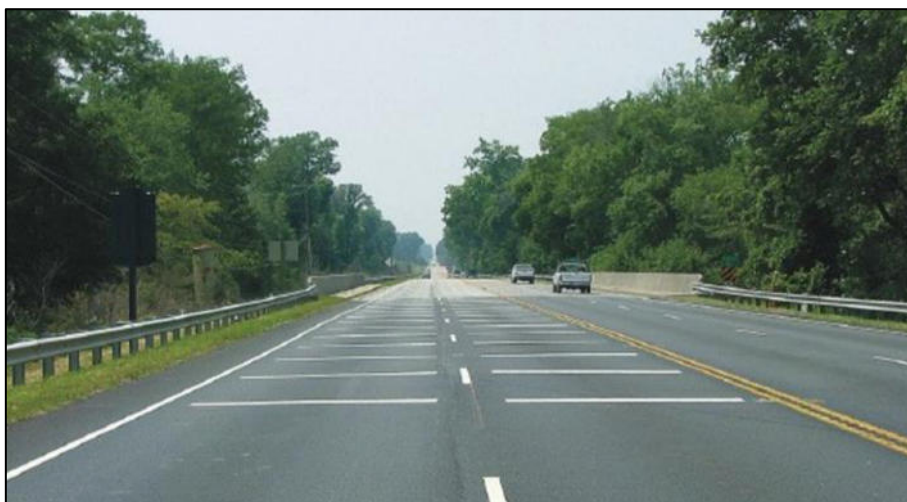
شکل ۶-۸- خط‌کشی نوار عرضی کامل
