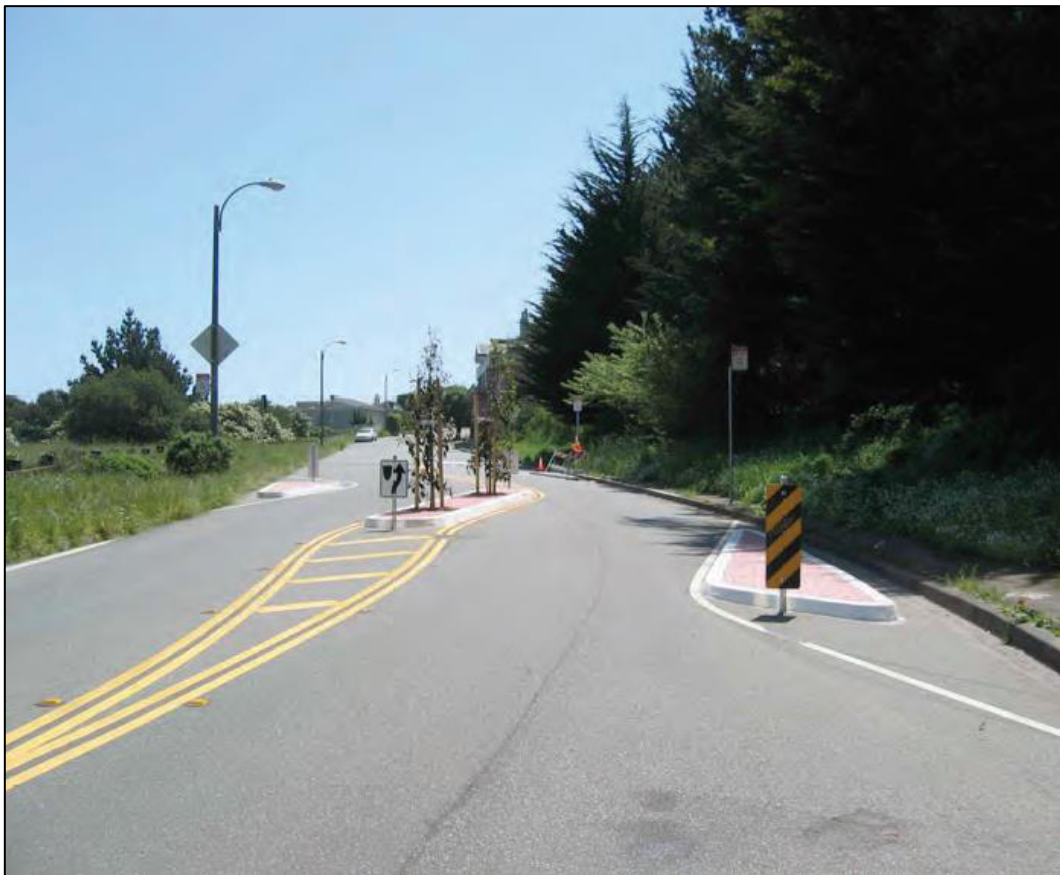
شکل ۹-۲- استفاده از پیچاننده به منظور آرام‌سازی ترافیک در نواحی تغییر سرعت
