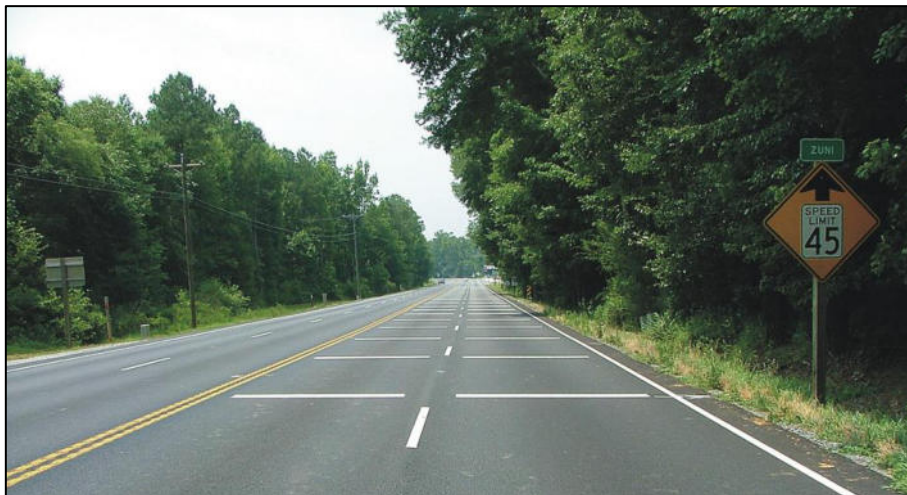
شکل ۹-۴- استفاده از تابلو و خط‌کشی به منظور آرام‌سازی ترافیک در ناحیه تغییر سرعت
