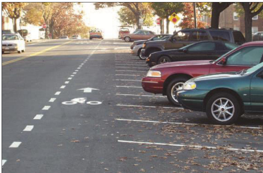
شکل ۳-۷- نمونه مسیر درجه ۲ در مجاورت خط پارک حاشیه‌ای مورب
