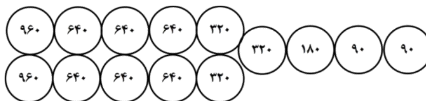
شکل ۶-۸- نحوه چیدمان بشکه‌های ماسه برای یک معبر با سرعت طرح ۱۰۰ کیلومتر بر ساعت
